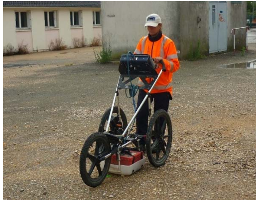
Figure 4 : Mise en œuvre du géoradar.
