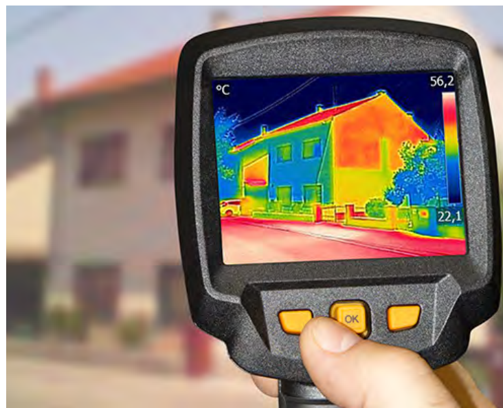
Repérez les déperditions de chaleur grâce à une caméra thermique.
