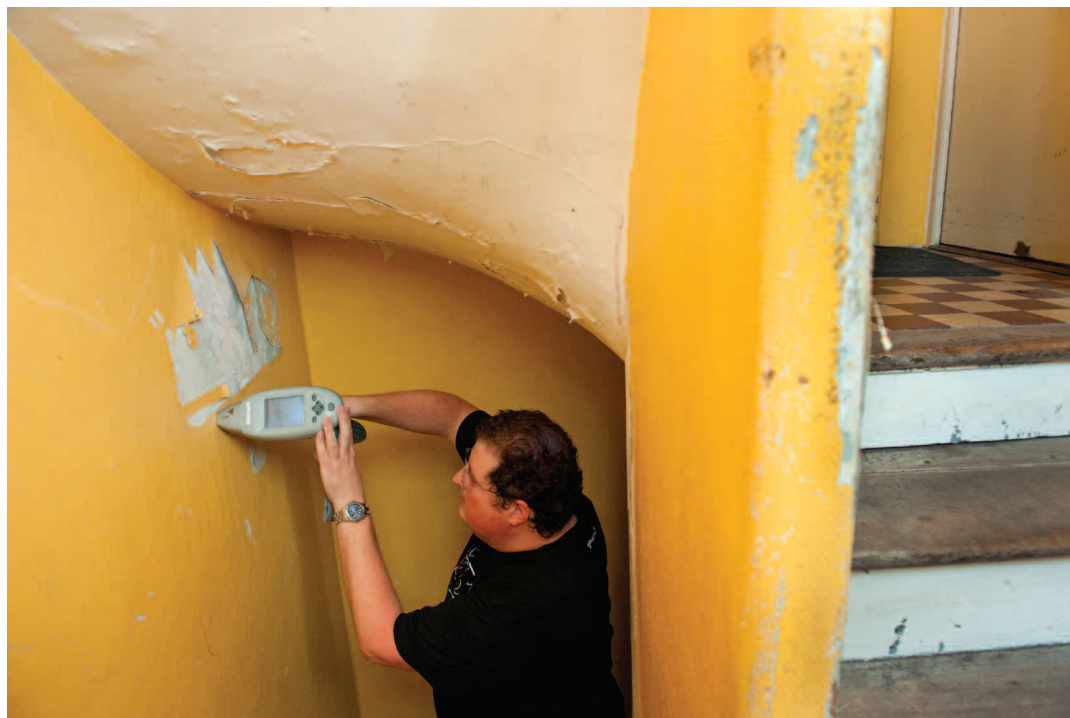
Quotidiennement, les agents de la mission saturnisme réalisent des diagnostics d'intoxication au plomb dans les immeubles construits avant 1949.
