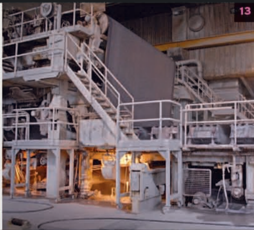
13 & 14 Cinquième étape : la fabrication du papier. Les machines à papier transforment la pâte en une feuille continue de papier journal. Le processus consiste à retirer l'eau par égouttage, pressage et séchage pour conférer à la feuille son état de surface définitif.
