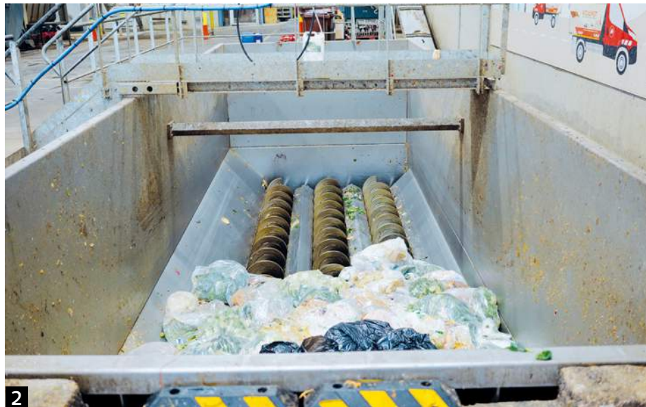
2 Les déchets sont d'abord triés, débarrassés des emballages plastiques, sacs et autres barquettes, puis transformés en « soupe ».
