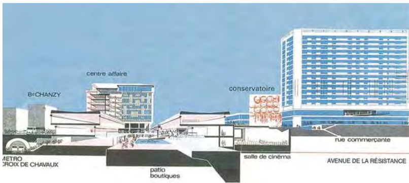
Schéma de rénovation urbaine et coupe de principe de la Croix de Chavaux
